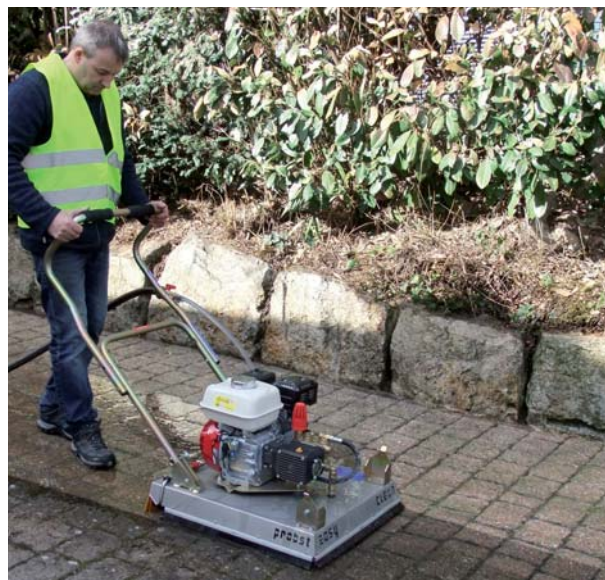
EASYCLEAN EC-60 Nettoyeur haute-pressure avec protection contre les projections
