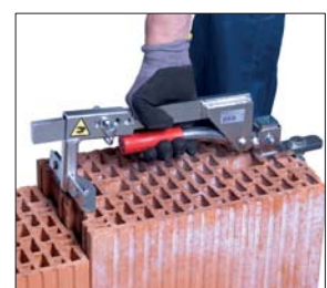
BLOCK CARRIER BC Pince à blocs
