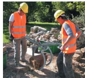
Pince manuelle pour blocs erratiques H-FVZ-UNI
