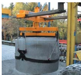
Système mécanique de manutention de regards par bande métallique MBG
