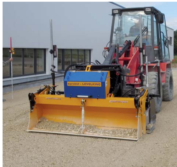
LEVELKING LK Outil de nivellement avec pelle basculante K5
